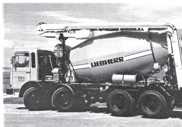
Fig. 20 : Bétonnière portée et tapis à béton
