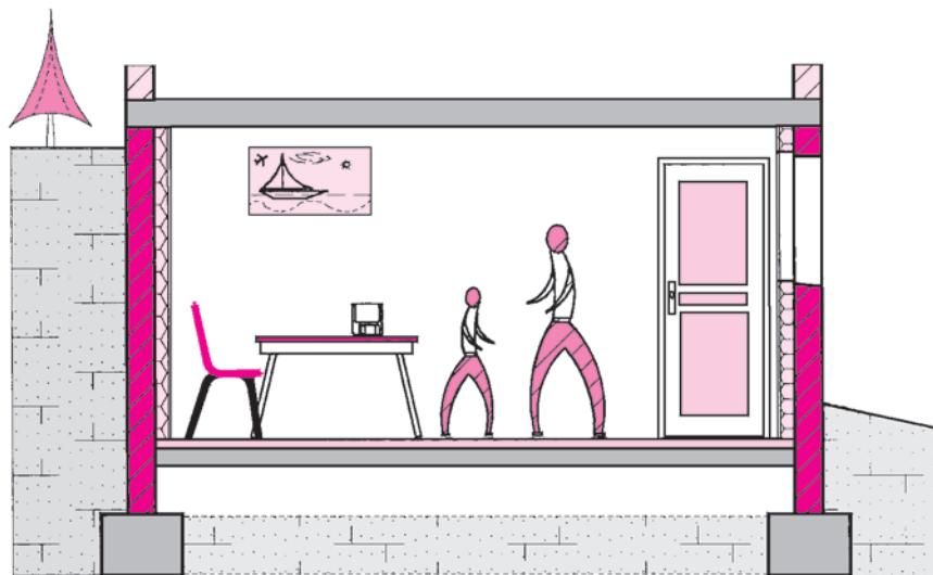
Fig. 6 : Parois de catégorie 1 pour zone habitable
