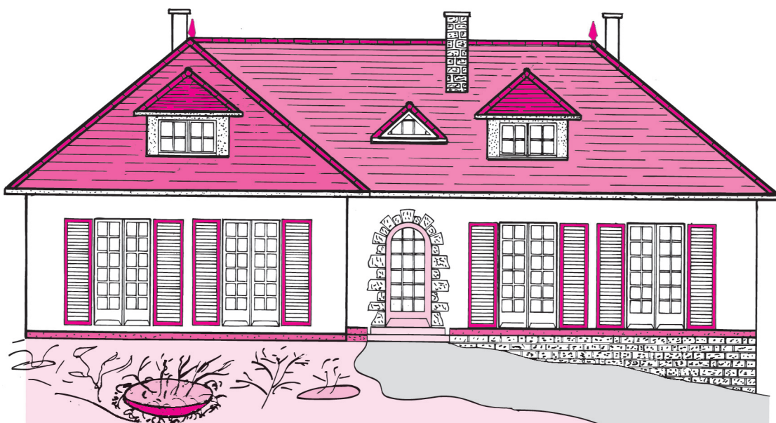
Fig. 33 : Mur enterré complètement au droit du séjour, et partiellement enterré au droit de la salle à manger
